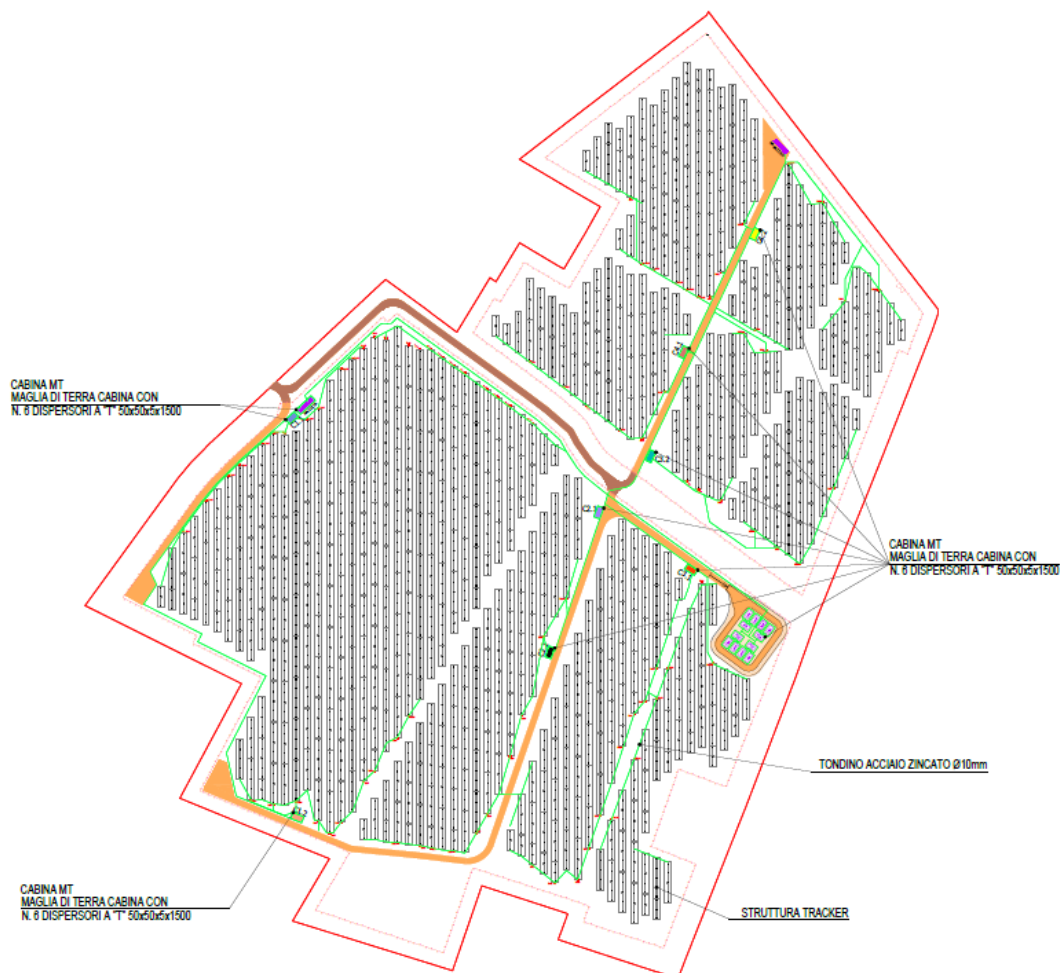
Figura 3: Rete equipotenziale impianto agrivoltaico
